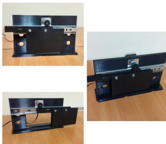
Рис. 3. Собранный прототип управляемого преграждающего устройства
