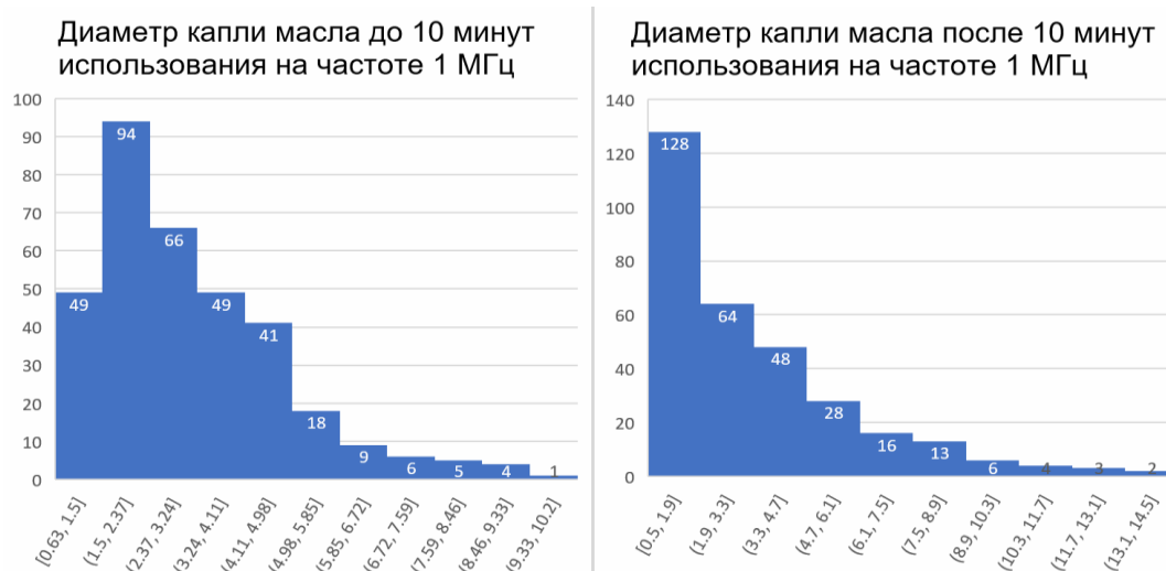
Рис. 6. Распределение капель масла в эмульсии в начале и конце при 1 МГц (Классические методы)
