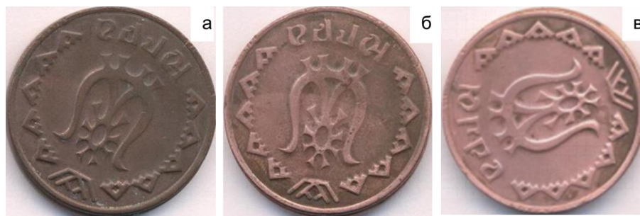
Рис. 1. Неочищенная поверхность монеты (а), очистка поверхности монеты в течение одной недели (б), в течение двух недель (в)
