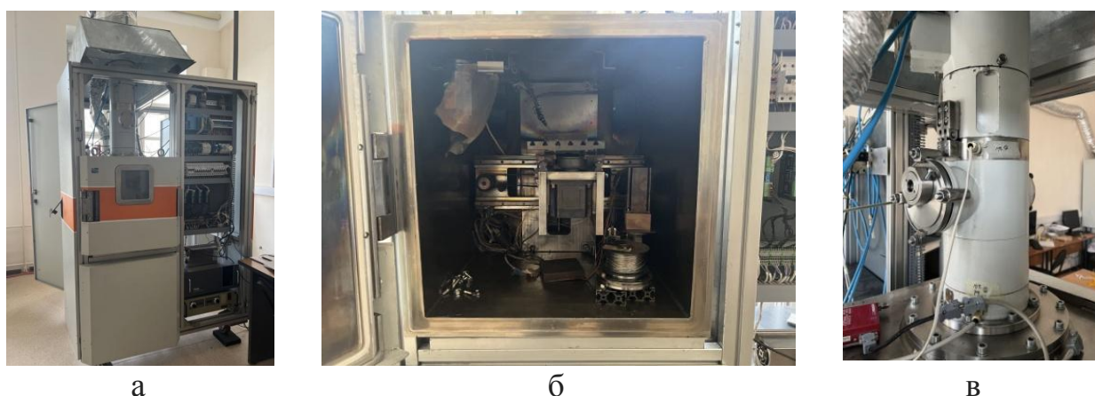
Рис. 2. Схематическое изображение конструкции установки для электронно-лучевой аддитивной печати ТПУ: а) внешний вид оборудования, б) рабочая камера для печати, в) место для технологического окна для монтажа системы видеорегистрации
