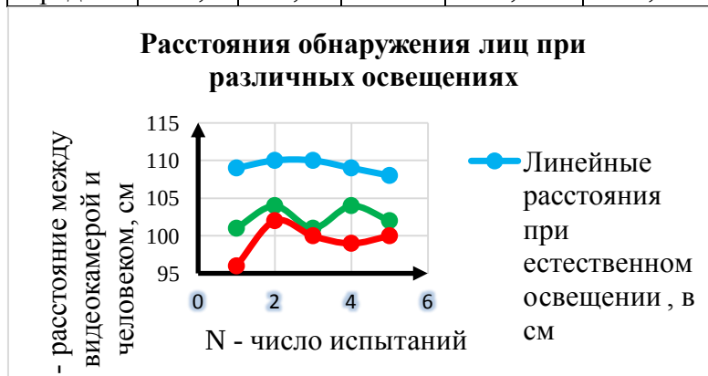
Рис. 5. Графики зависимости расстояния обнаружения лиц от условий освещения
