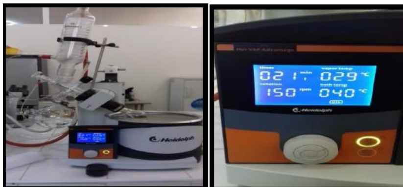
Рис. 1. Концентрирование растительных экстрактов на ротавапоре (Heidolph, Германия)
