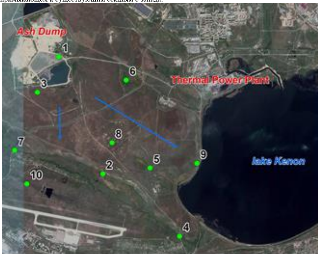
Рис. 1. Местоположение ТЭЦ-1, золоотвала и пунктов опробования подземных и поверхностных вод: 1 – на сбросе пульпы в ГЗО; 2, 3, 8-10 – скважины; 4, 7 – р. Кадалинка; 5 – ручей; 6 – родник. Стрелками показано направление движения подземных вод
