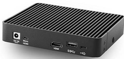
Рис. 2. Миниатюрный компьютер с пассивным охлаждением
