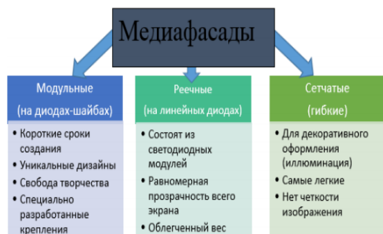
Рис.2. Виды конструкции медиафасадов
