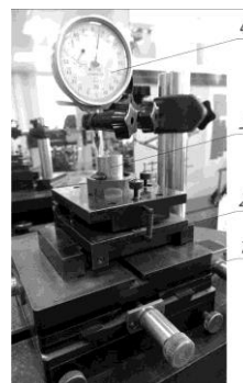
Рис. 2. Приспособление для измерения размеров наплывов металла на торцах образцов: 1 – двухкоординатный микрометрический стол; 2 – двухповоротный стол; 3 – образец; 4 – измерительная головка
