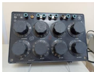
Рис. 2б. Внешний вид магазина сопротивлений P 4831
