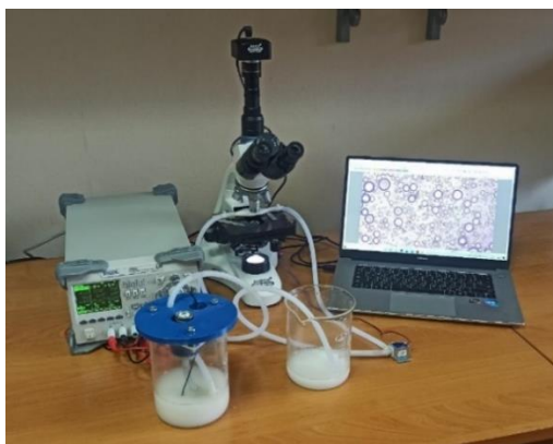
Рис. 1. Программно-аппаратный комплекс для определения дисперсного состава водомасляных эмульсий
