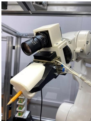
Рис. 2. Робот-манипулятор с установленными камерой и креплением под карандаш
