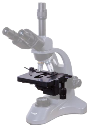
Рис. 1. Механический предметный столик серийного тринокулярного микроскопа (выделен)
