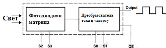
Рис. 2. Функциональная схема датчика TCS230
