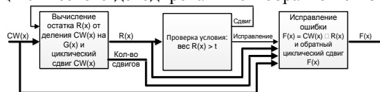
Рис. 2. Структурная схема устройства циклического декодирования
