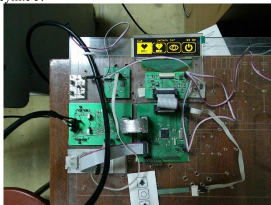
Рис. 4. Макет для экспериментов с биоимпедансом
