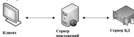
Рис. 1. Трёхуровневая архитектура системы оповещения
