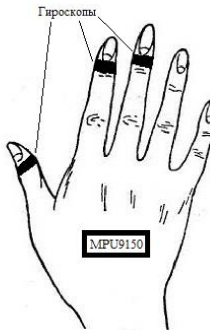
Рис. 1. Схематичное расположение датчиков на руке пользователя
