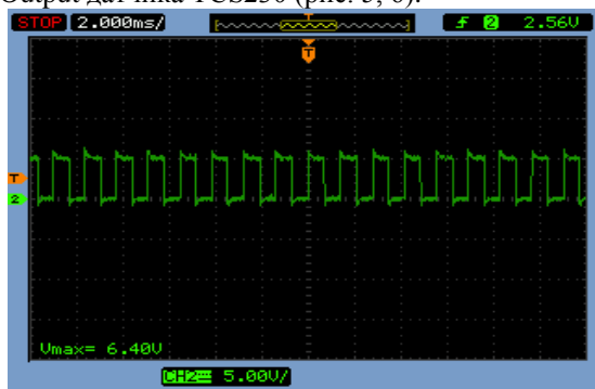
Рис. 5. Осциллограмма, снятая при красном цвете LCD
