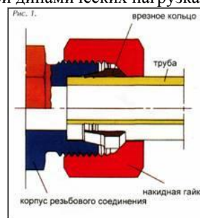
Рис. 1. Резьбовые соединения с врезным кольцом
