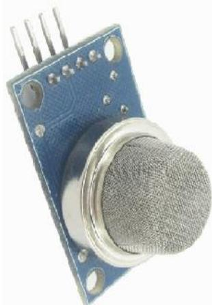
Рисунок 1 - Газоанализатора MQ-2
