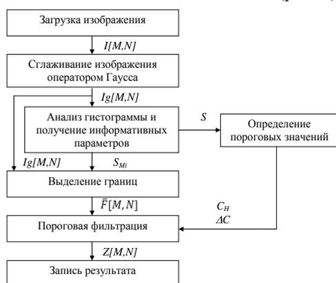
Рис. 2. Структурная схема алгоритма выделения границ
