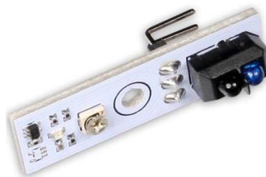
Рисунок 1 - бинарный датчик линии
