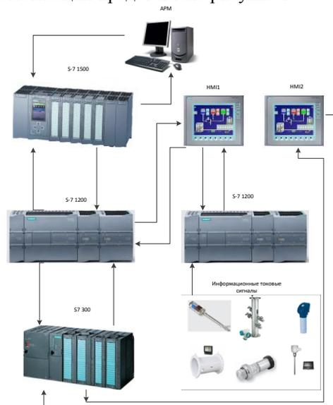
Рис. 1. Структурная схема автоматизации
