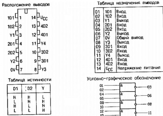
Рис. 3. Микросхема КР1533ЛА3
