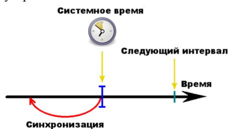
Рис. 2. Рассинхронизация программных таймеров
