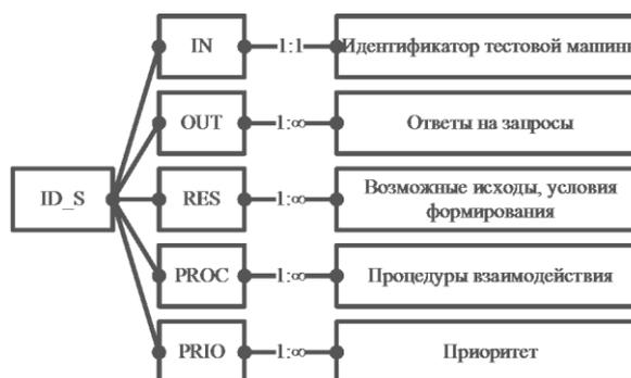
Рисунок 1 - Дескриптор для сценария анализа состояния тестового устройства
