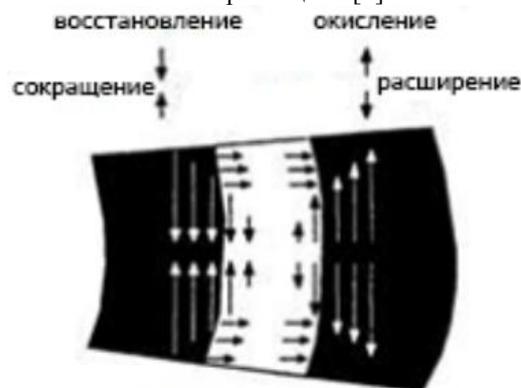
Рисунок 2 - Механизм деформации трехслойной структуры [9]
