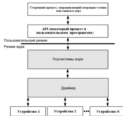
Рис. 2 – Функциональная схема информационно-логического взаимодействия между драйвером и процессом
