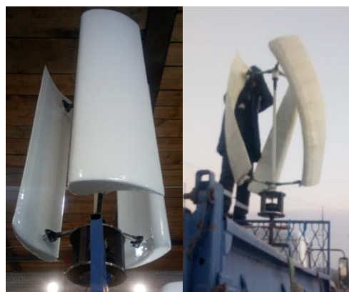
Рис. 5. Изготовленные лопасти на основе 3D – моделей
