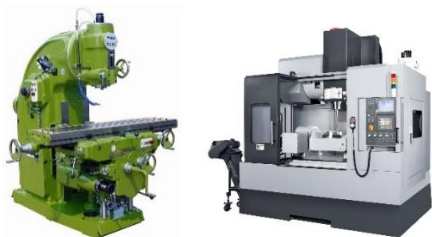
Рис. 1. Фрезерный станок традиционный и с ЧПУ
