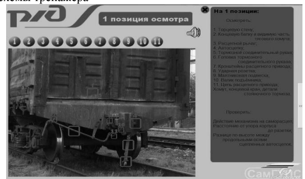
Рис. 3. Модуль первой позиции осмотра вагона
