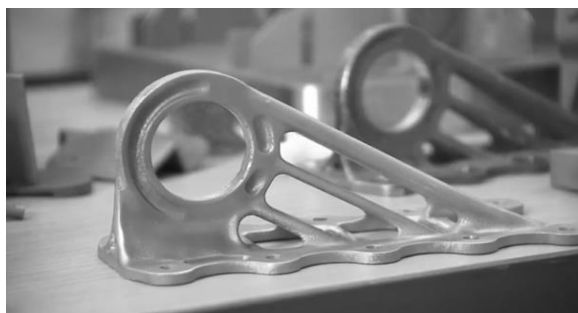
Рис.1. 3D-печатная металлическая деталь компании Airbus
