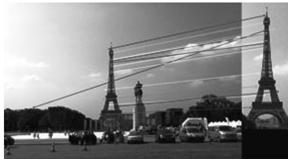
Рис. 3. Результат применения FlannBasedMatcher и перспективных преобразований
