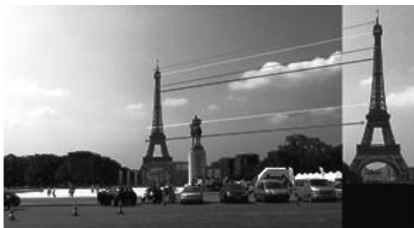
Рис. 2. Результат применения FlannBasedMatcher
