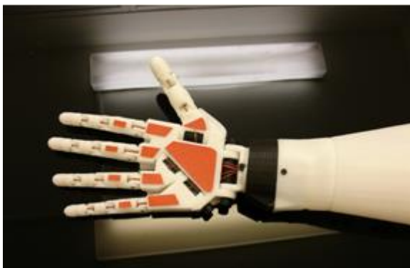
Рис.1. Антропоморфный захват InMoov
