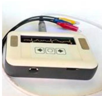
Рис. 1. Внешний вид разработанного прибора вместе с внешним кабелем для грудных отведений
