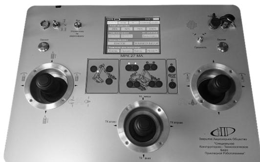
Рис. 4. Модернизированный пульт дистанционного управления для семейства МРК
