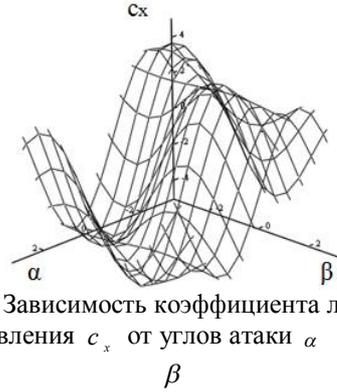
Рис. 4. Зависимость коэффициента лобового сопротивления  $c_x$  от углов атаки  $\alpha$  и дрейфа  $\beta$
