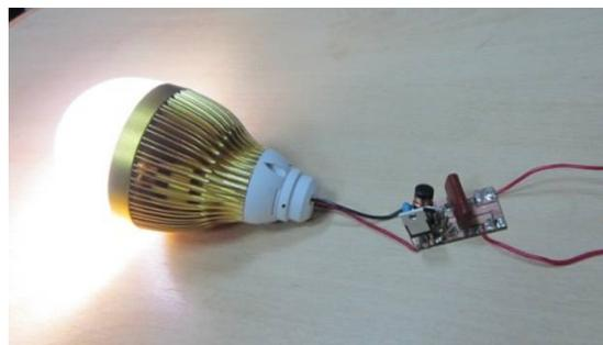
Рисунок 3 – Собранный печатная плата управляемого драйвера
