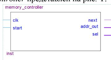
Рис. 1 Модуль *memory\_controller*
