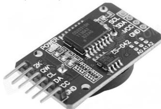
Рис. 4 Часовой модуль DS3231
