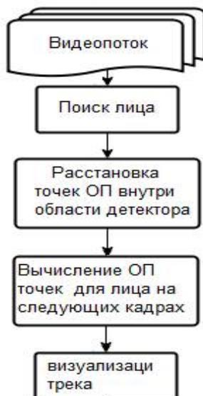
Рис.3. Упрощенная схема работы алгоритма отслеживания лица человека
