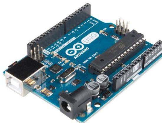
Рис. 1. Плата Arduino UNO
