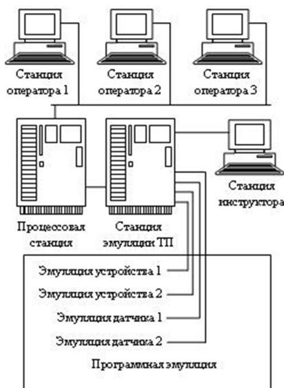
Рис. 1. Типовая структура тренажеров оператора
