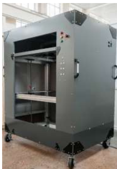
Рисунок 1 – Стационарная установка термоакустического контроля дефектов полимерных композиционных материалов
