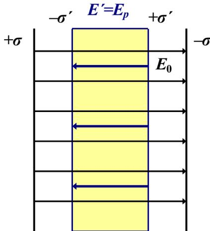
Пластины, заряженные свободными зарядами с поверхностной плотностью заряда  $\pm\sigma$ , создают внешнее поле  $E_0$ .
