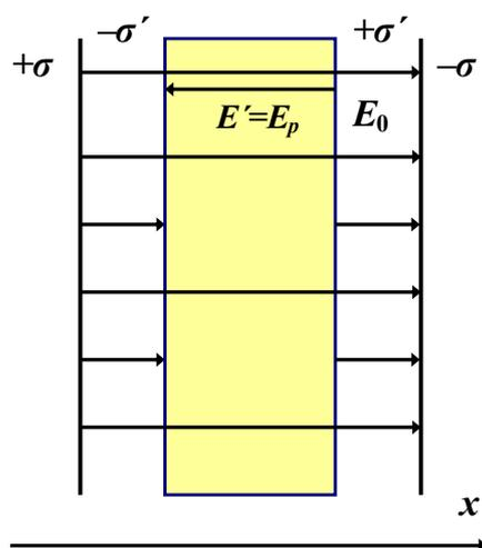
Внешнее поле  $\vec{E}_0$  создается двумя бесконечными пластинами с поверхностной плотностью заряда  $+\sigma$  и  $-\sigma$ .
