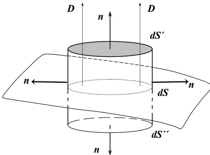
Выделим на поверхности проводника произвольную площадку  $dS$ . Построим на ней цилиндр высотой  $dh$  с образующей, перпендикулярной площадке  $dS$ .
