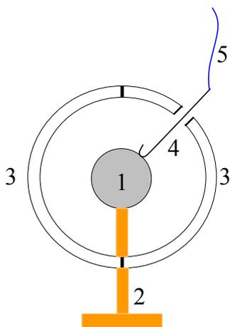
В этих опытах металлический шар 1 был укреплен на изолирующей подставке 2. Две металлические полусферы 3 могли быть соединены в одну сферу, охватывающую шар 1.
