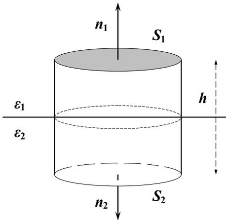
• Выделим на границе раздела диэлектриков цилиндрическую поверхность высотой  $h$ . Основание  $S_1$  расположено в первом диэлектрике,  $S_2$  – во втором диэлектрике.
