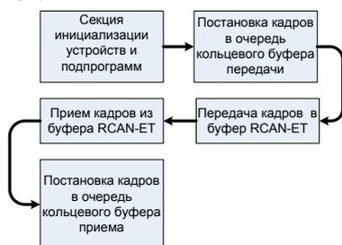
Рис. 1. Общая схема передачи данных между узлами сети CAN
