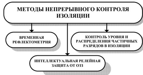
Рис. 2. Методы непрерывного контроля изоляции
