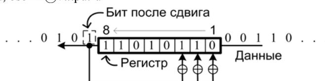
Рис. 1. Схематичное представление работы стандартного алгоритма на примере CRC8 ( $x^8+x^2+x+1$ )
