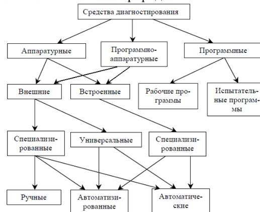
Рис. 3. Классификация средств технического диагностирования
