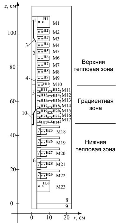
Рис. 1. Разрез установки для выращивания кристаллов. Обозначения: 1) воздух; 2) паровая фаза над расплавом; 3) ампула; 4) тигель; 5) рабочее вещество; 6) теплоотвод; 7) тепловые шунты; 8) теплоизолятор; 9) подставка установки; 10) затравочный кристалл; Н1–Н30 и М1–М23 – нагревательные элементы и модули
