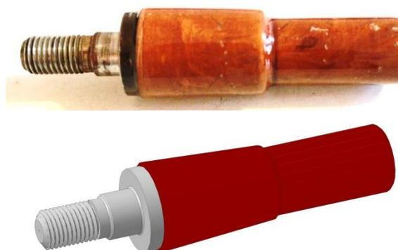
Рис. 1. Изоляционный палец электродвигателя и его твердотельная модель
