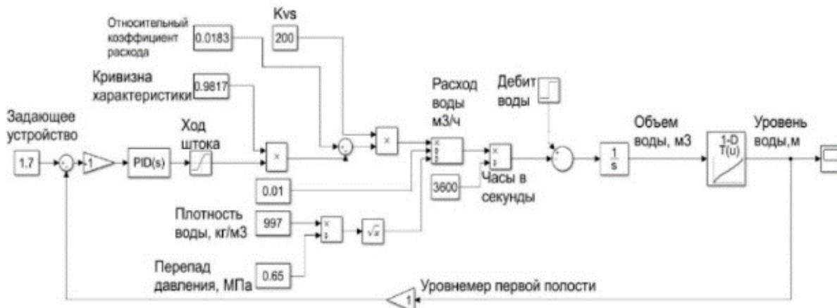
Рис. 1. Контур регулирования уровня воды
