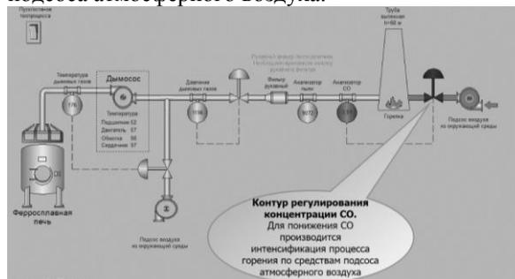
Рис. 4. Контур регулирования CO
