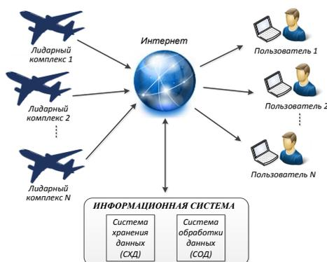
Рис. 1. Структура комплекса технических средств информационной системы
