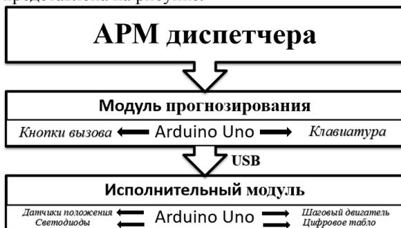
Рис. 1. Схема системы из двух контроллеров
