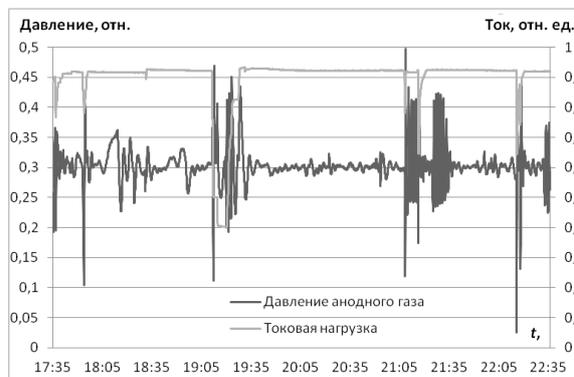
Рис. 2. График работы узла стабилизации анодного газа
