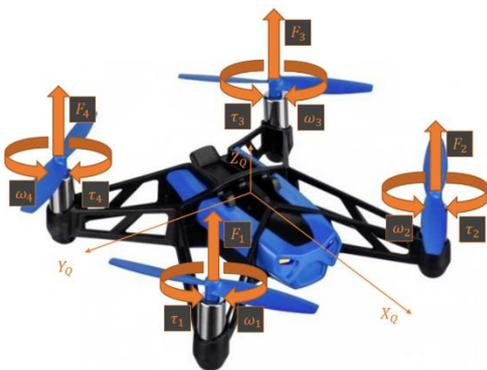
Рис. 1. Модель квадрокоптера Parrot со связанной системой координат
