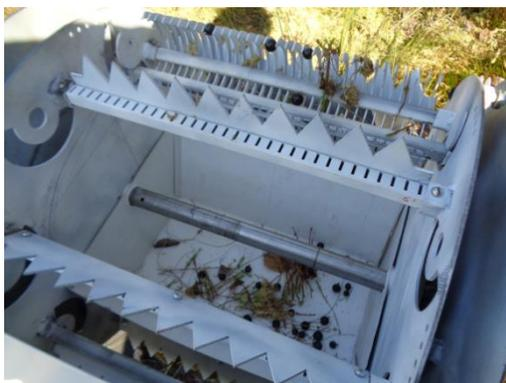
Рис. 1. Макетный образец узла сбора.
