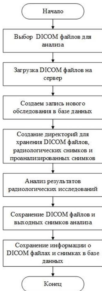
Рис. 2. Блок-схема алгоритма анализа результатов радиологических исследований.
