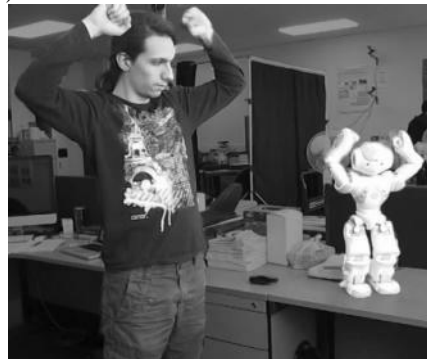
Рис. 3. Имитация движений оператора роботом
