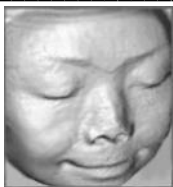
Рис. 9 Результат снятия материала с заготовки при автоматической обработке
