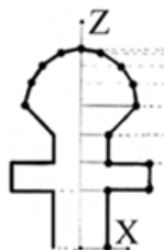
Рис. 6 Общее представление режущего инструмента как множества цилиндрических и конических участков
