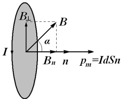
Вектор  $\vec{B}$  разложим на два вектора
