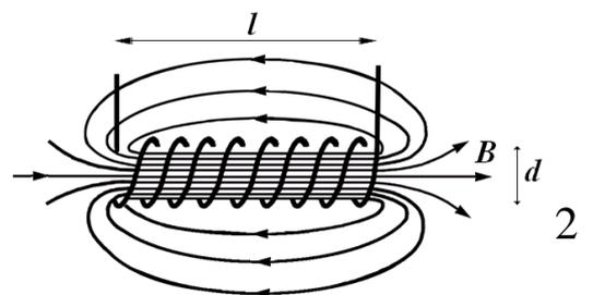
$l \gg d$ ; в этом случае эксперимент показывает, что  $B_{\text{внутри}} = \text{const}$ , а вне соленоида поле мало.
