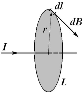
В качестве контура выберем окружность радиуса  $r$  перпендикулярную току и имеющую центр на оси тока. В этом случае контур совпадает с силовой линией вектора магнитной индукции  $\mathbf{B}$  и из соображений симметрии во всех точках, лежащих на одинаковом расстоянии от проводника, модуль вектора  $\mathbf{B}$  одинаков.
