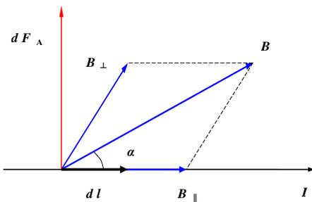
Элементарная сила  $d\vec{F}$ , действующая на малый элемент длины  $dl$  проводника с током, находящийся в магнитном поле индукцией  $\vec{B}$ , прямо пропорциональна силе тока  $I$  в проводнике и векторному произведению  $[d\vec{l}, \vec{B}]$ .
